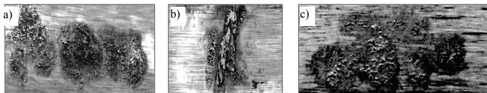
Rys. 3. Nieregularne wżery na bieżni zewnętrznej pierścienia wewnętrznego –a), krater na powierzchni wewn. pierścienia wewnętrznego –b) oraz krater na powierzchni pierścienia zewnętrznego –c)
