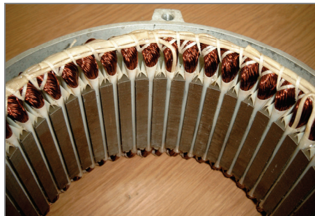
Rys. 1. Uzwojony stojan prądnicy – widoczne proste żłobki Fig. 1. Winding of the stator – apparent straight grooves
