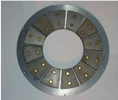
Rys. 3. Tarcza jarzmowa z przykręconymi magnesami Fig. 3. Yoke disc with screwed magnets
