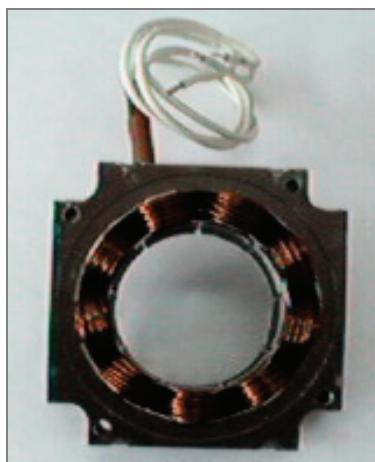
Rys. 1. Uzwojony stojan silnika bezszczotkowego – uzwojenie skupione Fig. 1. Coil winding stator of brushless motor
