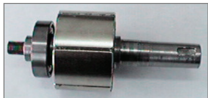
Rys. 3. Kompletny wirnik silnika Fig. 3. Complete rotor of motor
