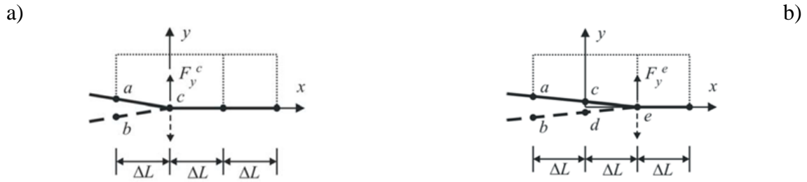
Rys. 5. Lokalna konfiguracja siatki elementów skończonych stosowana w technice MCCI: a) pierwszy i b) drugi, wariant analizy po przedłużeniu pęknięcia
