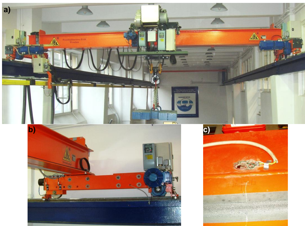
Rys. 5. Widok eksperymentalnego ustroju nośnego dźwignicy z asymetrycznie usytuowanym dźwigarem względem kół jezdnych: a) widok z poziomu torowiska, b) widok geometrii ustroju nośnego względem kół jezdnych, c) punkt pomiarowy w środku rozpiętości ustroju nośnego
