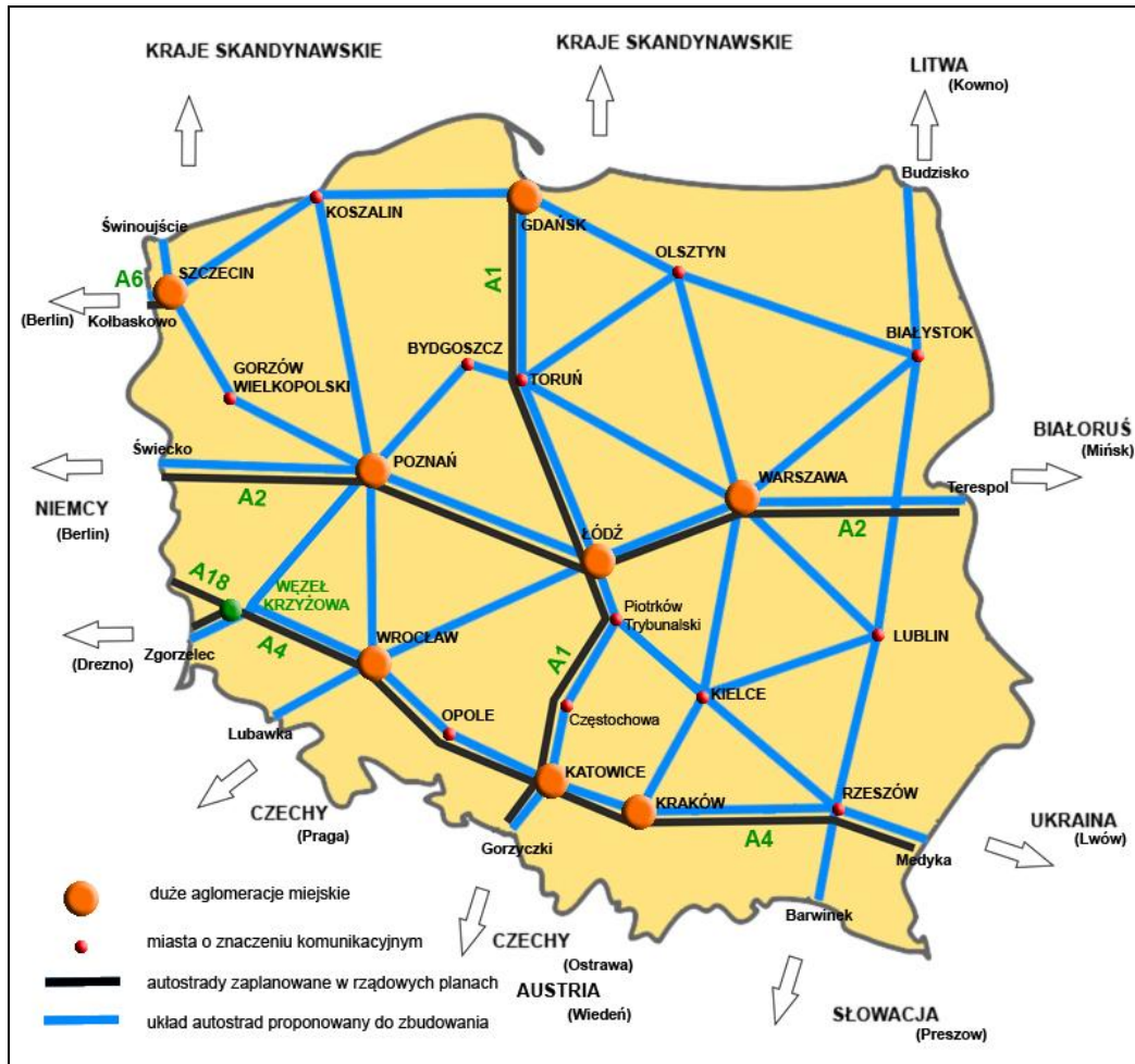
Rys. 16. Proponowany układ przebiegu sieci autostrad
