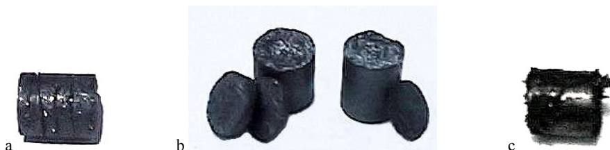
Rys. 3. Typowe uszkodzenia próbek wykonanych z proszku magnetycznie twardego H: a – bez dodatku dielektryku – podczas wyjmowania z formy, b, c – z 2% dodatkiem dielektryku – podczas magnesowania
