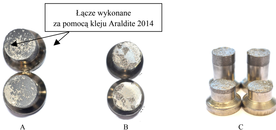
Rys. 8. Próbkę po testach wytrzymałościowych Fig. 8. Samples after strength tests
