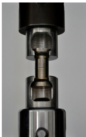
Rys. 4. Próbką umieszczona w uchwytach maszyny zrywającej Fig. 4. The sample located in holders of breaking machine
