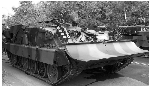
Rys. 2. Wóz Zabezpieczenia Technicznego WZT-3 na podwoziu czołgu T-72 WZT
