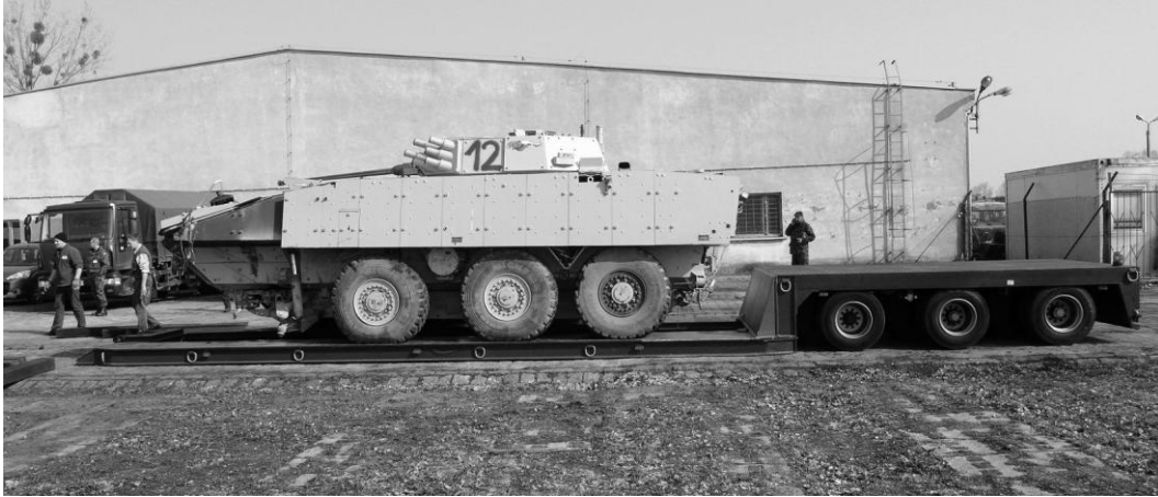
Rys. 10. Uszkodzony pojazd KTO Rosomak po załadunku na prototypową platformę do przewozu uszkodzonych KTO Rosomak transportem lotniczym
