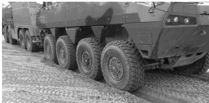
Rys. 6. Próba holowania pojazdu z niesprawnym układem hamulcowym
