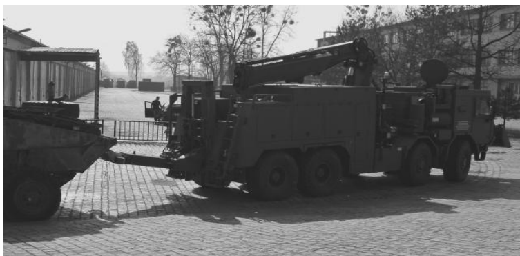
Rys. 8. Tylny wysięgnik podczas holowania uszkodzonego pojazdu
