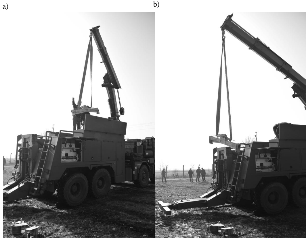
Rys. 4. Zabudowa specjalistyczna w KWZT-1 a) wyposażenie w szafach, zakabinowy żuraw, b) tylne ramie holownicze
