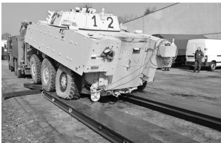
Rys. 9. Załadunek uszkodzonego pojazdu na prototypową platformę do przewozu uszkodzonych KTO Rosomak transportem lotniczym
