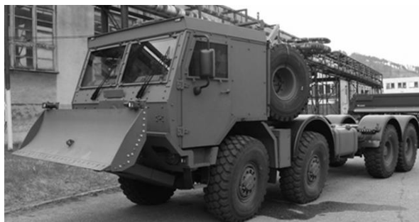
Rys. 3. Podwozie Tatra 8x8 przed zabudową
