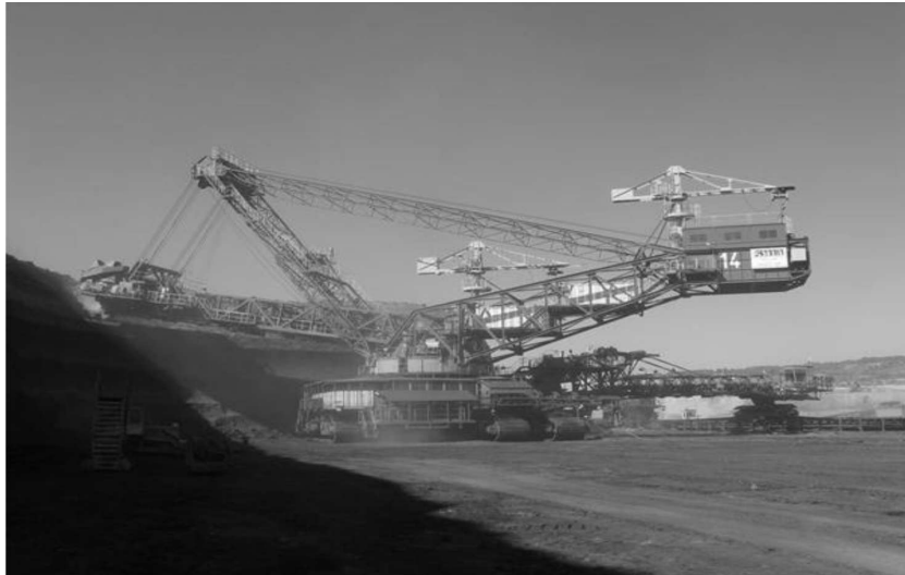
Rys. 4. Koparka KWK 1200M Źródło: Opracowanie własne
