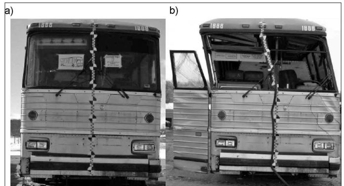
Fot. 4. Przykład badań nadwozia autobusu wykonanych wg testu ECE R-66[4]; a – przed testem, b – po teście z widocznym odkształceniem części pasażerskiej nadwozia autobusu
