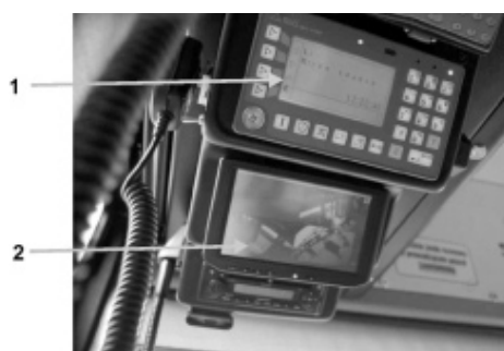
Fot. 5. Monitoring wizyjny przestrzeni pasażerskiej w kabine kierowcy autobusu [8]; 1 – pulpit kontrolno-sterowniczy, 2 – monitor systemu nadzoru
