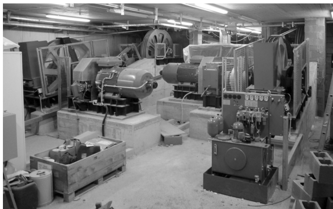
Fot. 5. Układy napędowe kolei wraz z kołami kierunkowymi znajdujące się w stacji górnej (fot. Andreas Jenny)
