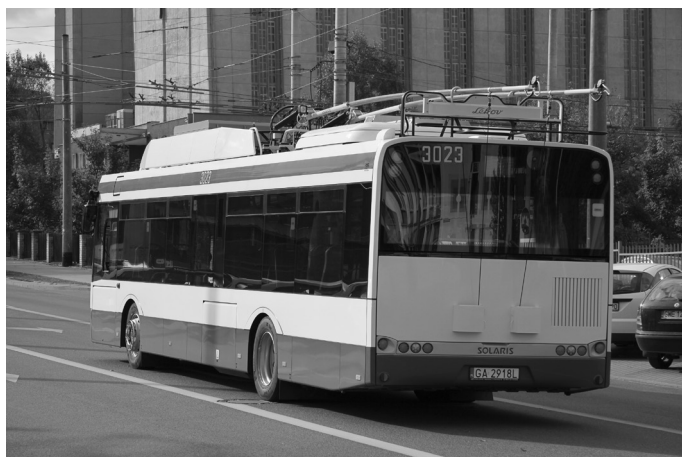
Fot. 7. Gdyniński trolejbus, który dzięki dodatkowym akumulatorom (ze złożonymi pantografami bez korzystania z sieci zasilającej) może przejechać kilka kilometrów po dowolnej trasie Źródło: materiały MZKG.
