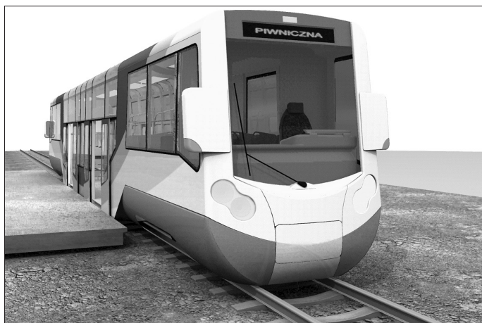
Rys. 4. Model pojazdu kolejki Piwniczna–Szczawnica
