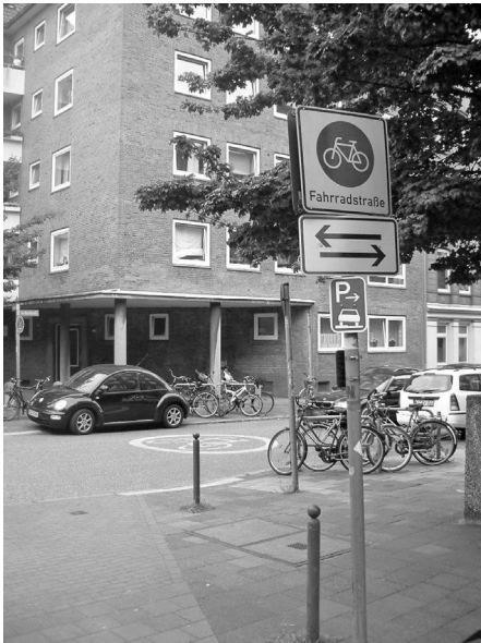
Fot. 2. Oznakowanie pionowe ulicy rowerowej. Ulica rowerowa nie traci swojej ciągłości w przypadku skrzyżowań z ulicami podrzędnymi – to auta przejeżdżające przez ulicę rowerową muszą stosować się do jej przepisów. Na jezdni widać znak poziomy ulicy rowerowej (fot. M. Beim).
