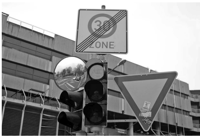
Fot. 2. „Trixi-Spiegel” – lustro umożliwia kierowcom pojazdów ciężarowych obserwację tzw. martwego pola, walnie przyczyniając się do poprawy bezpieczeństwa rowerzystów (fot. Michał Beim).
