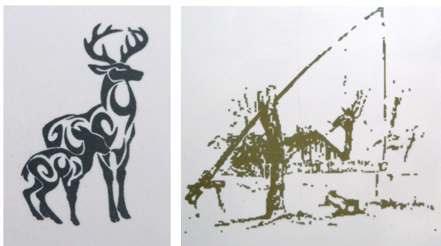
Rys. 14. Przykłady zdobienia płytek ceramicznych wykonane metodą platerowania laserowego w Instytucie Ceramiki i Materiałów Budowlanych
