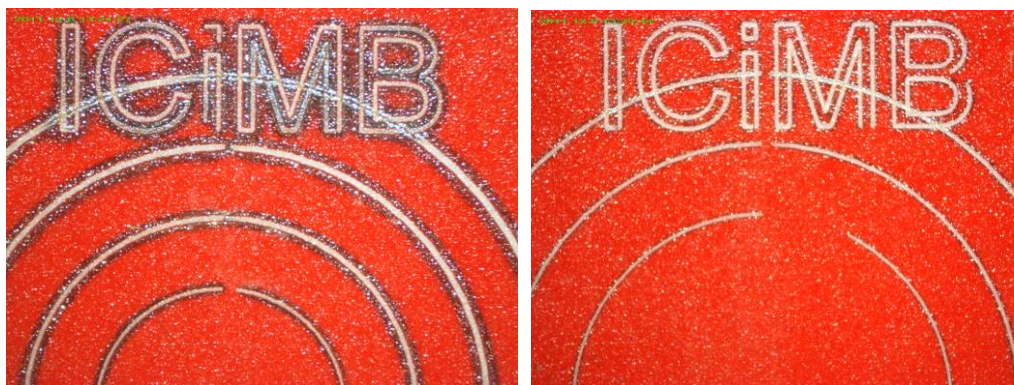
Rys. 5. Mikroskopowe fotografie wyników laserowej aktywacji próbki pokrytej czerwonym pigmentem K-164 za pomocą lasera iterbowego ciągłego działania. Moc lasera 5, 10, 15 i 20 W dla kolejnych okręgów, licząc od środka. Z lewej prędkość skanowania 40 mm/s, z prawej prędkość skanowania 100 mm/s dla każdego okręgu
