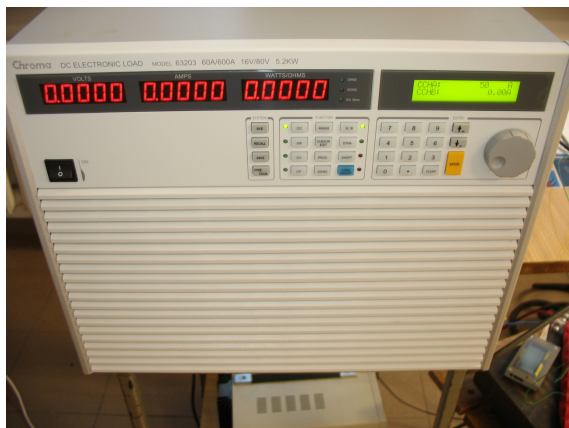
Rys. 4. Widok programowalnego obciążenia prądu stałego
