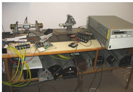
Rys. 3. Stanowisko do badania generatorów
