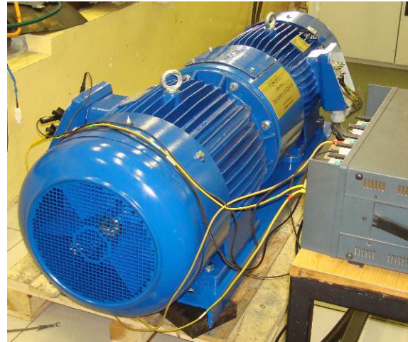
Rys. 19. Stanowisko pomiarowe generatora w wykonaniu specjalnym w laboratorium maszyn elektrycznych BOBRME KOMEL
