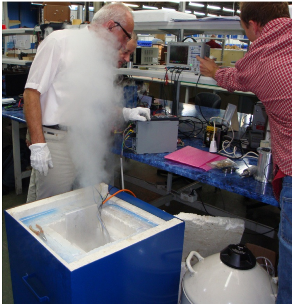
Rys. 8. Silnik prototypowy podczas prób w ciekłym azocie
