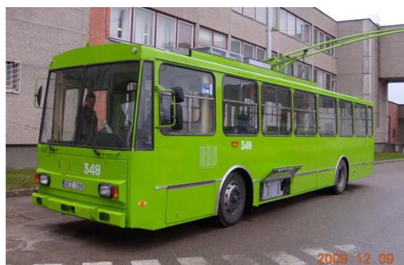
Rys.1. Zmodernizowany trolejbus Skoda 14TR z napędem asynchronicznym wyposażonym w zasobnik superkondensatorowy
