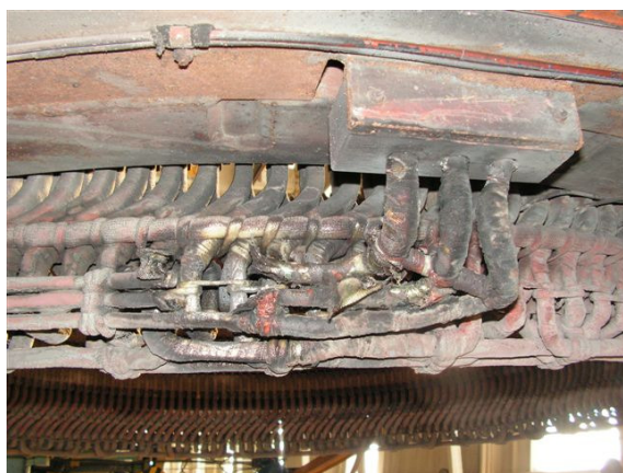
Rys. 3. Skutki zwarcia w uzwojeniach
