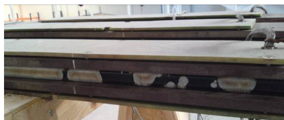
Rys. 10. Uszkodzona warstwa półprzewodząca pręta generatora podczas próby starzeniowej izolacji
