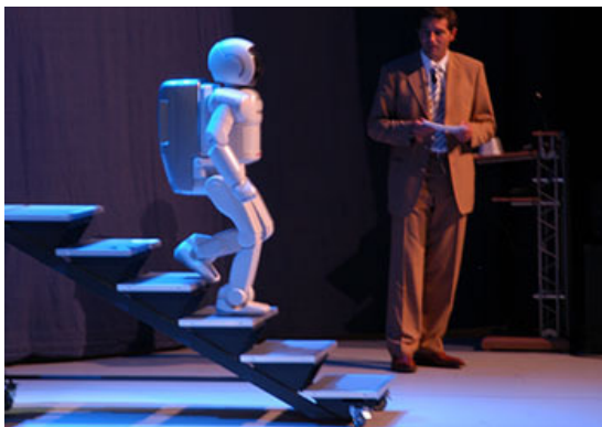
Rys. 3. Robot ASIMO schodzący po schodach [7, 8]
