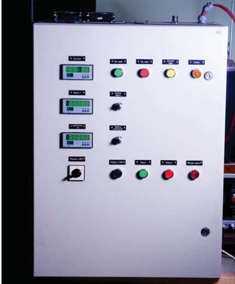
Rys. 4.7. Przekształtnik probierczy PT-01 (a) oraz oscylogram impulsu napięciowego z przekształtnika probierczego PT-01 (b)
