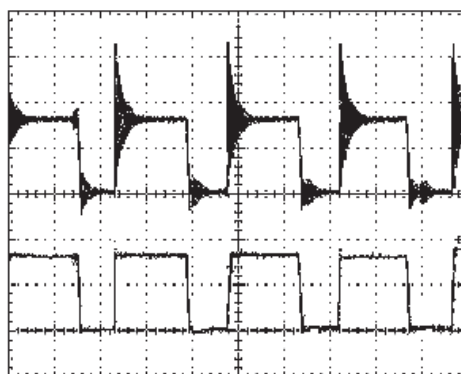
Rys. 2.4. Oscylogram napięcia na wyjściu z przekształtnika (na dole) oraz na zaciskach silnika (na górze)
