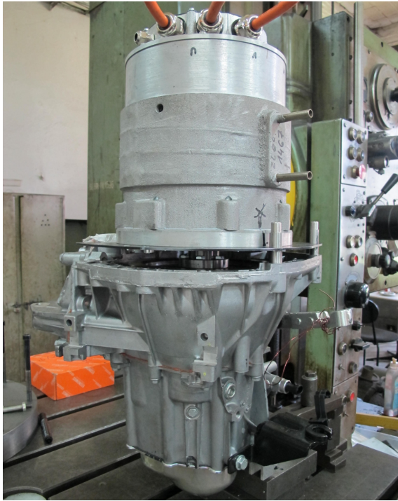
Rys.4. Silnik IPMSM typ SMKwsg132-6 podczas próbnego montażu do skrzyni biegów samochodu osobowego (Fiat Panda 2012)
