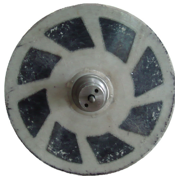
Rys. 18. Model wirnika silnika tarczowego z wirnikiem wewnętrznym
