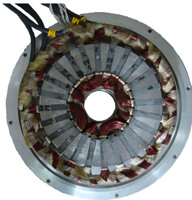
Rys. 17. Stojan silnika tarczowego z wirnikiem wewnętrznym
