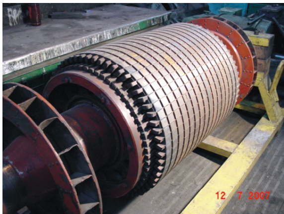
Rys. 8. Zmodyfikowany wirnik silnika 2000/500 kW, 1500/750 obr/min, stan po odbyciu 70000 rozruchów [5]
