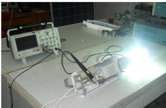
Rys. 11. Widok stanowiska do badania statecznika dławikowego (klasycznego)
