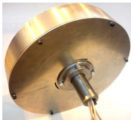
Rys. 2. Bezrdzeniowy silnik tarczowy z magnesami trwałymi wykonany w Instytucie Elektrotechniki
