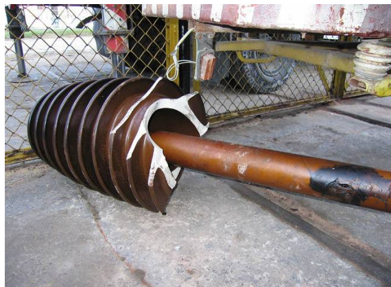
Rys. 1. Uszkodzony przepust izolatorowy 110 kV transformatora 70 MVA
