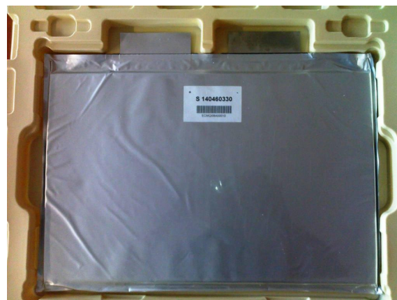
Rys. 4. Zastosowane ogniwo litowe wraz z jego parametrami znamionowymi
