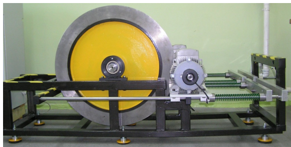
Rys. 11. Stanowisko do odwzorowywania stanów niustalonych grupowego napędu trakcyjnego
