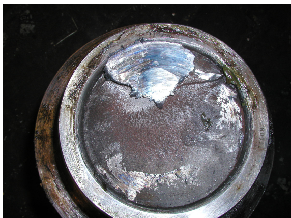
Rys. 4. Widok złomu urwanego wału silnika
