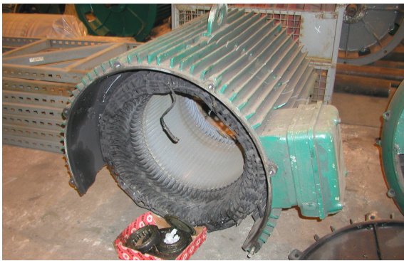
Rys. 15. Zniszczony korpus silnika i uzwojenie stojana
