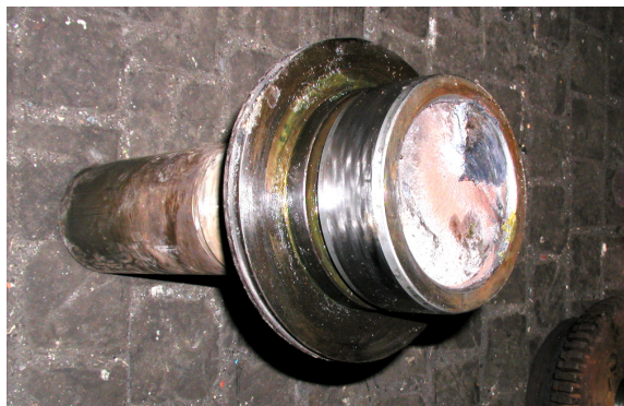
Rys. 3. Fragment urwanego wału silnika
