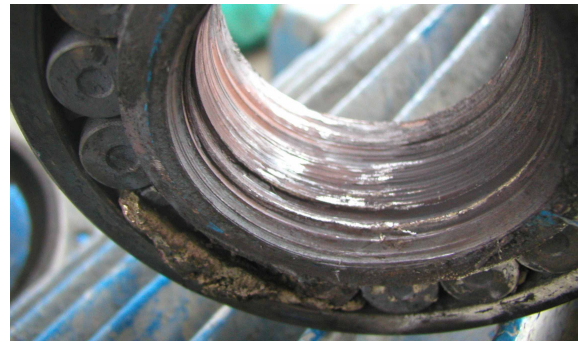
Rys. 16. Zniszczony: a) - czop łożyskowy, b - pierścień wewnętrzny łożyska
