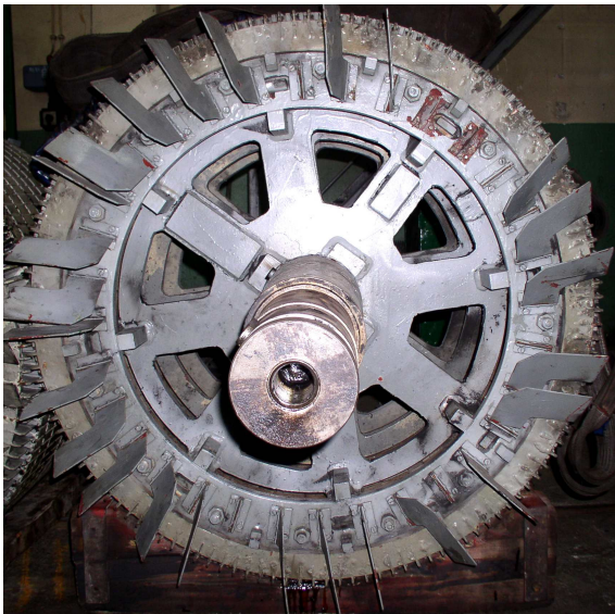
Rys. 7. Widok uszkodzonego wentylatora
