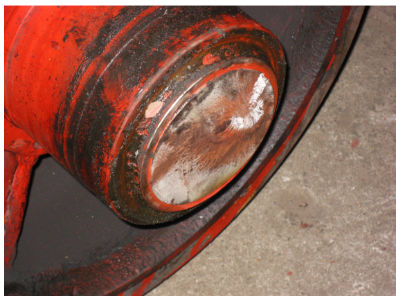
Rys. 5. Miejsce urwania wału silnika dwuklatkowego
