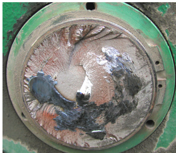
Rys. 2. Widok złomu urwanej końcówki wału silnika
