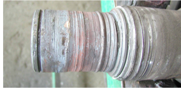
Rys. 12. Zgięta końcówka wału bez tarczy sprzęgła
