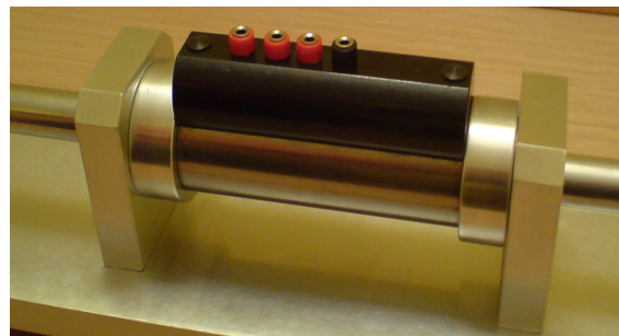
Rys. 5. Stojan zamocowany do podstawy.
