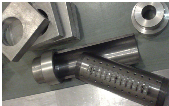
Rys. 2. Dzielona tuleja stojana, aluminiowe końcówki i wsporniki.
