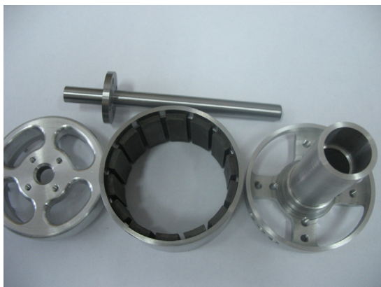
Rys.21. Widok tarcz łożyskowych, wirnika i wałka wykonanego silnika BLDC
