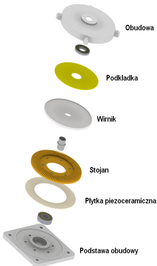
Rys. 4 Elementy silnika pierścieniowego.
