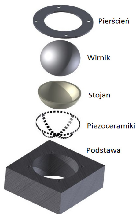
Rys. 8 Elementy silnika sferycznego o 3 stopniach swobody.
