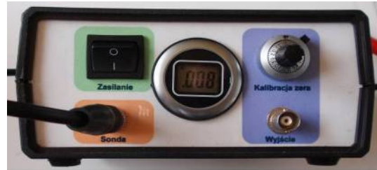
Rys. 5. Magnetoskop wykonany na potrzeby grantu własnego
