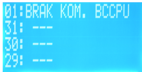
Rys. 7. Wynik badań diagnostycznych prostownika
