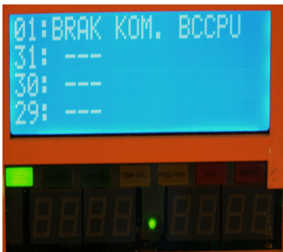
Rys. 5. Ekran wizualizacyjny stanów awaryjnych prostownika trakcyjnego
