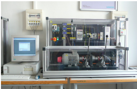
Rys. 1. Silnik prądu przemiennego na stanowisku diagnostycznym sterowany z przemiennika częstotliwości
