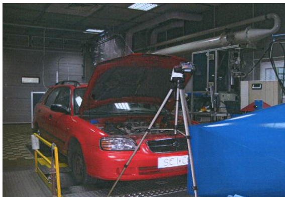
Rys. 9. Samochód badawczy z układem Stop&Go na stanowisku pomiarowym (BOSMAL)
