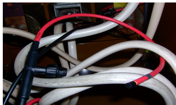
Rys. 7. Elastyczne cewki Rogowskiego, pomiar prądu silnika
