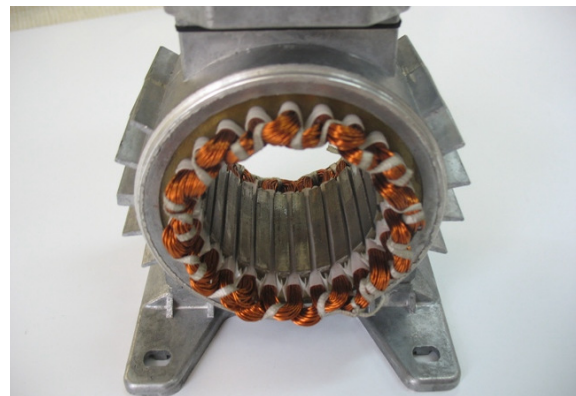
Zdjęcie nr 2. Uzwojeny stojan prądnicy
