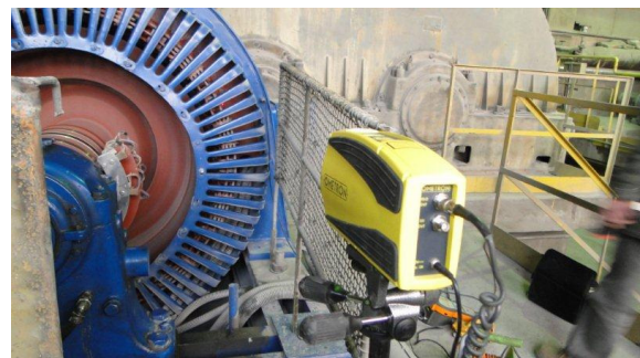
Rys. 14. Bezdotkowy pomiar drgań czoła uzwojeń stojana SYUe-148r/01, 1000kW
