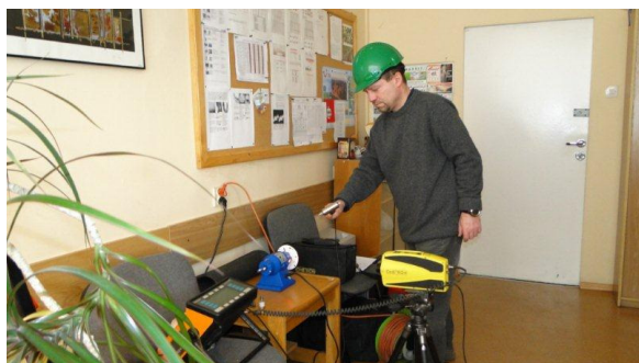
Rys. 22. Pobudzenie do drgań silnika w warunkach laboratoryjnych i rejestracja odpowiedzi układu przy pomocy wibrometru laserowego
