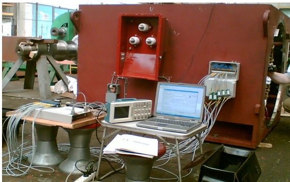
Rys. 10. Widok badanego stojana silnika oraz stanowisko pomiarowe w czasie kalibracji torów pomiarowych
