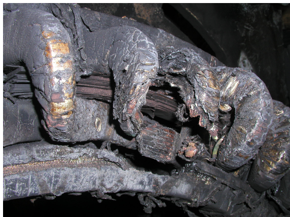
Rys. 6. Skutki zwarcia zwojowego w strefie główek cewek
