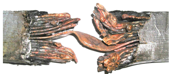
Rys. 2. Uszkodzenia uzwojenia w żłobkach rdzenia stojana: a) - wysunięte kliny żłobkowe, b) - zwarcia zwojowe i wypalenie klinów żłobkowych, c) - miejscowe zwarcia w cewce
