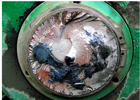
Rys. 14. Złomy zmęczeniowy urwanych wałów wirników: a) - wewnątrz i b) - zewnątrz silnika
