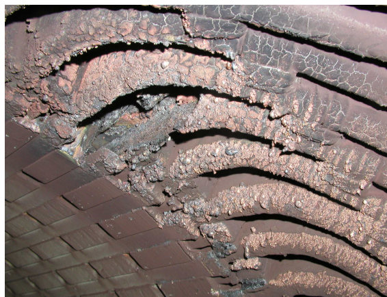
Rys. 5. Skutki zwarcia zwojowego na wyjściu cewki ze żłobka stojana
