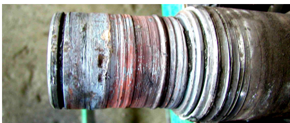
Rys. 13. Uszkodzenia łożysk tocznych i ich skutki: a) i c) – uszkodzone łożyska, b) – uszkodzone uzwojenie stojana, d) – zniszczony czop łożyskowy po uszkodzeniu łożyska (rys. c)
