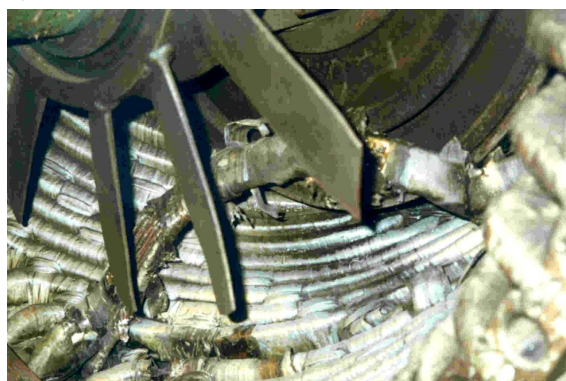
Rys. 4. Deformacje promieniowe i obwodowe czoł cewek: a) - dwóch i b) - jednej skrajnej cewki w grupie fazowej uzwojenia stojana
