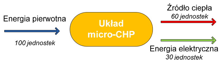
Rys. 1. Idea działania mikro-CHP [4]
